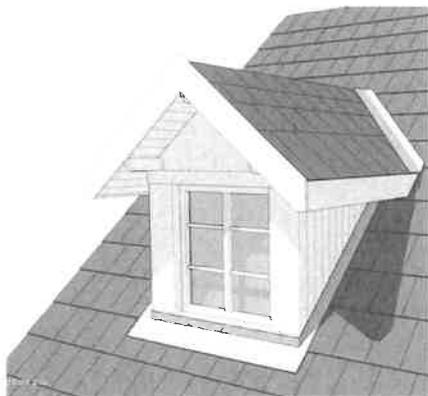
Figure 7 - Lucarne de type jacobine (source : toiture.pro)
